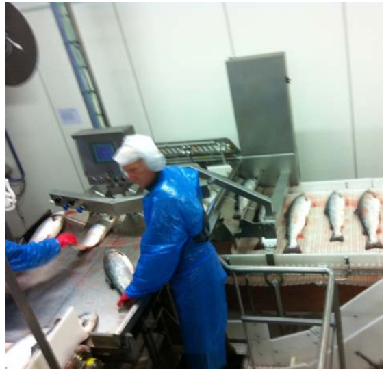
Figur 5-2; Manuell singulering og orientering for å posisjonere laksen riktig (hode/hale og rygg/buk).
