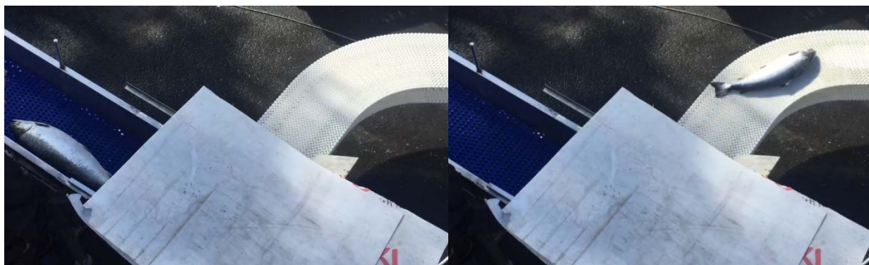
Figur 5-10; En laks kommer inn til vender med sporden først. Etter vending kommer laksen ut med hodet først. (Foto; SeaSide).
